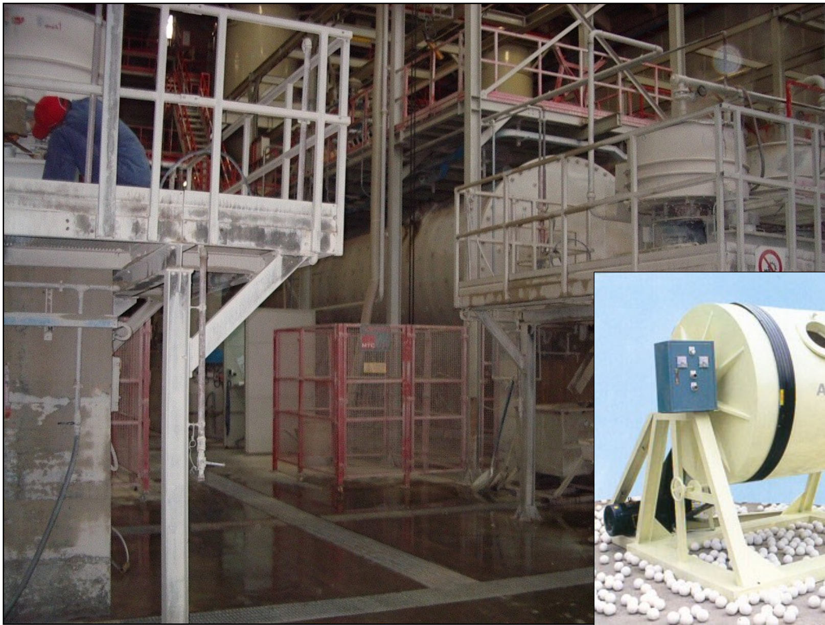
Il mulino per la macinazione ad umido delle materie prime
