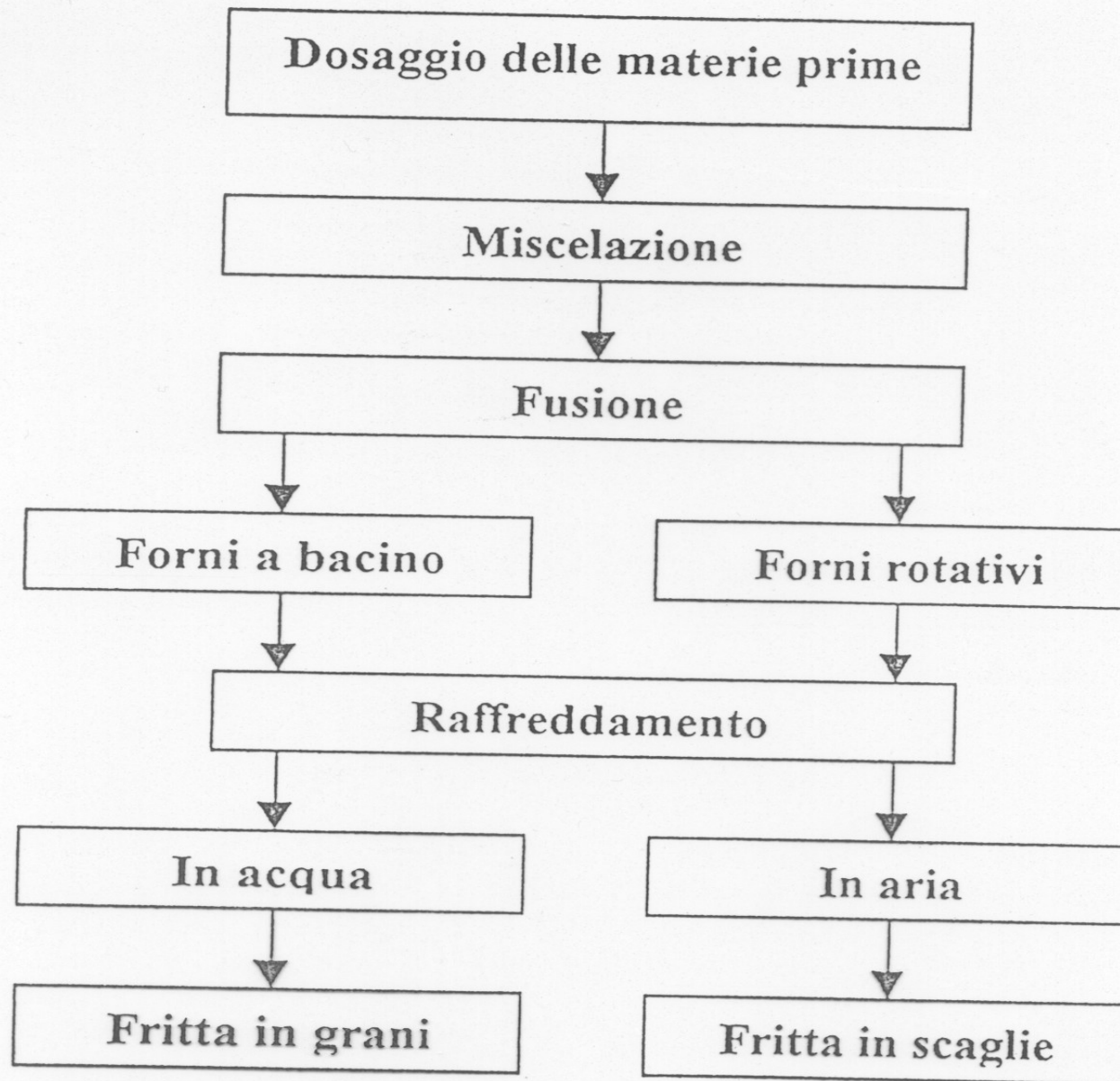
Schema di processo per la produzione di fritte
