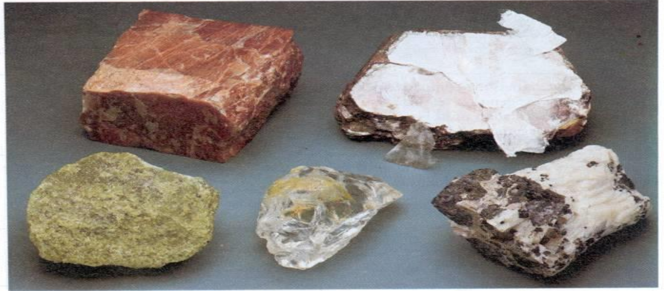
Figura 2.18. Minerali del gruppo dei silicati (in senso orario dall'alto a sinistra): feldspato, mica, pirosseno, quarzo e olivina. Chip Clark.
